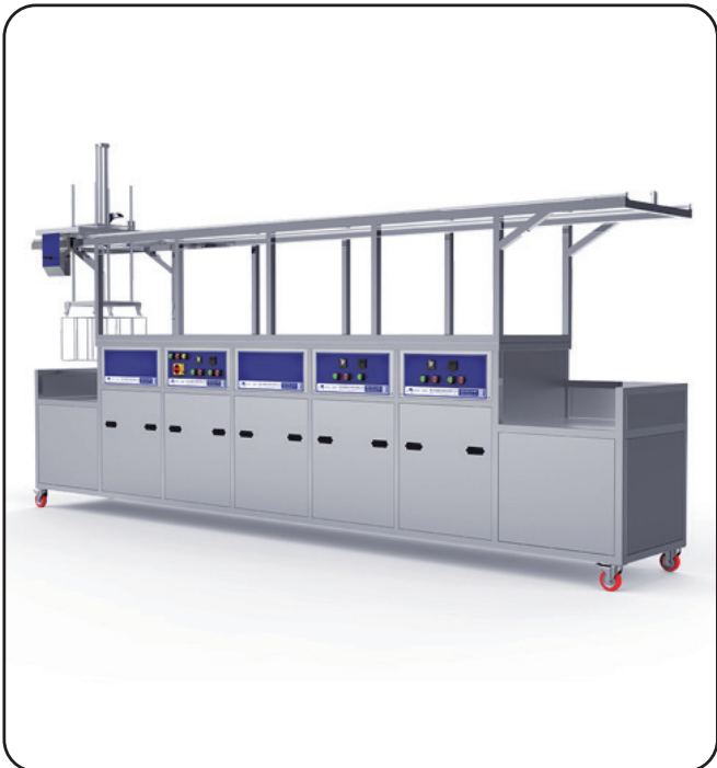
半自动化定制 可拆卸平移架组件
